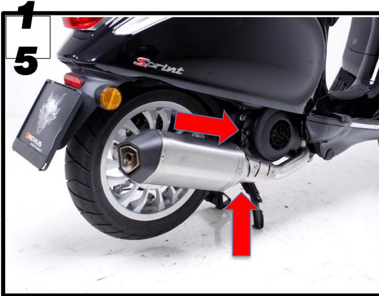
Befestigen Sie den Schalldämpfer mittels der mitgelieferten
